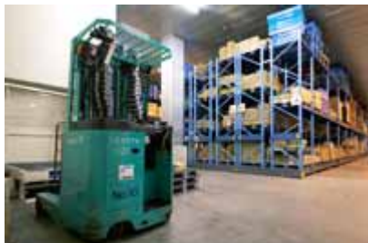
フォークリフトと移動ラック
